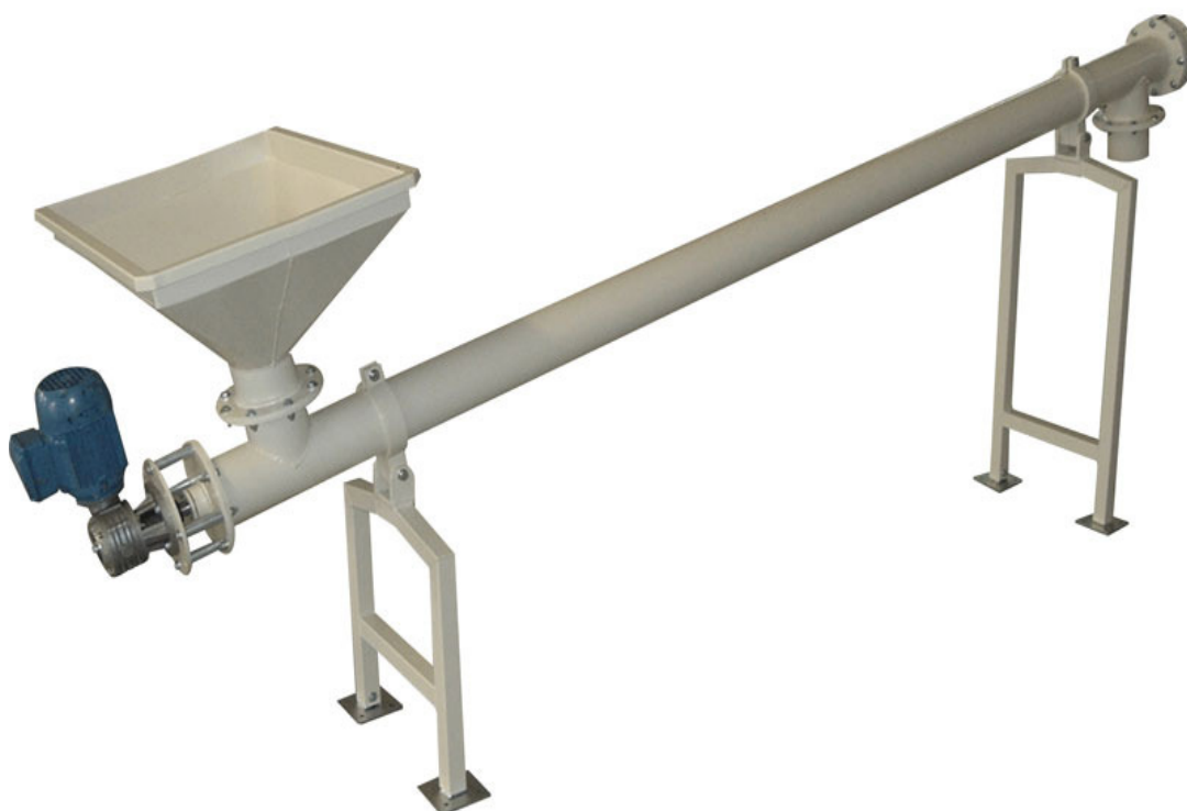
Figura 47 – Tipo de Esteira Transportadora com funcionamento por sistemas helicoidais (Fonte: SEE Sistemas, Produtos, 2009)
