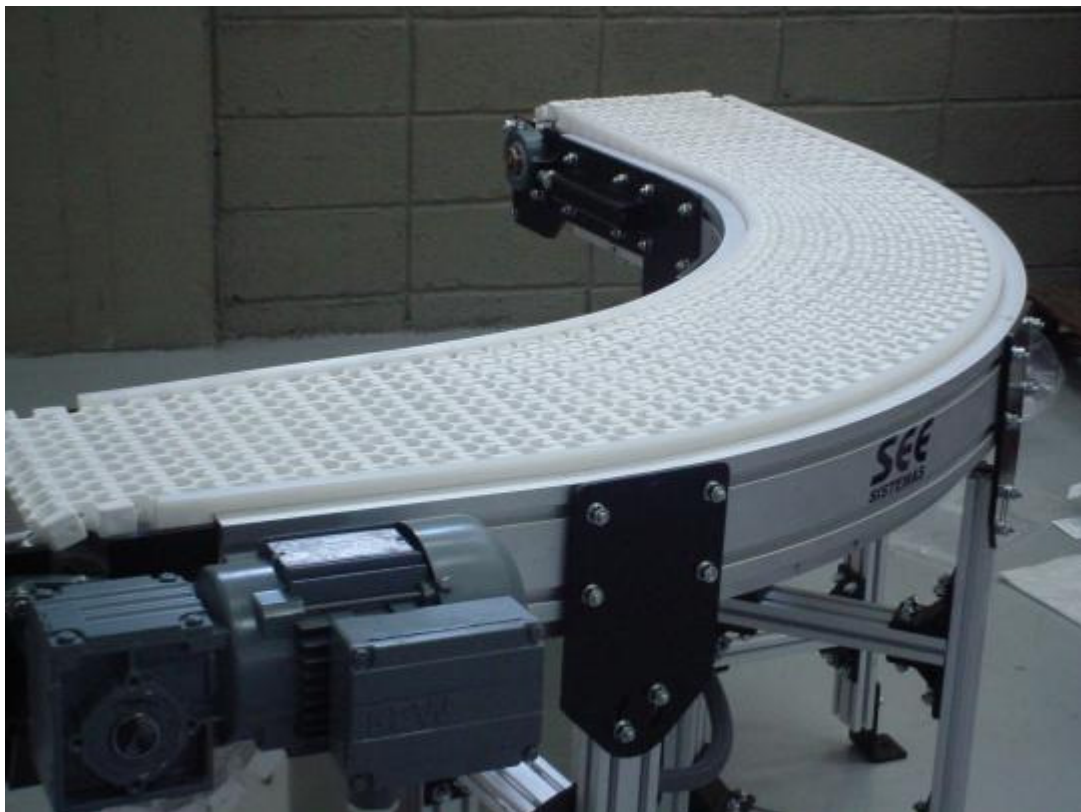
Figura 44 – Tipo de Esteira Transportadora com funcionamento por correntes (Fonte: SEE Sistemas, Produtos, 2009)
